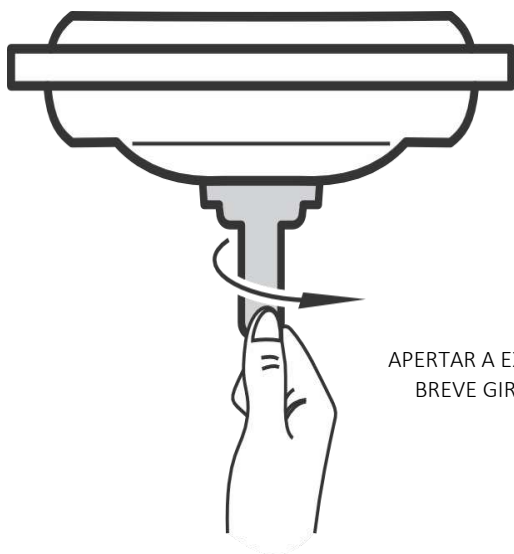
Figura 49 - Desacoplando a manopla de silicone
